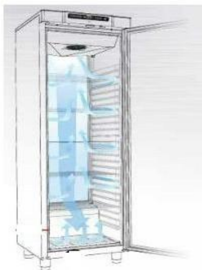
Figure 23. Enceinte thermostatique et répartition du froid
